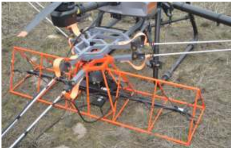
Магнітометри закріплено на спеціальній конструкції
