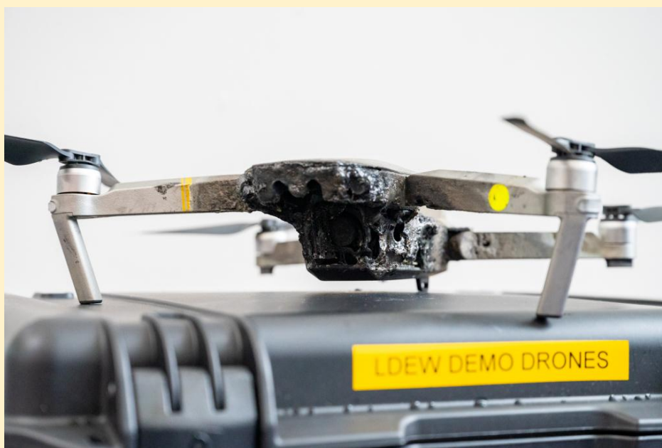
Пропалений лазером квадрокоптер. Джерело: MILITARNYI
