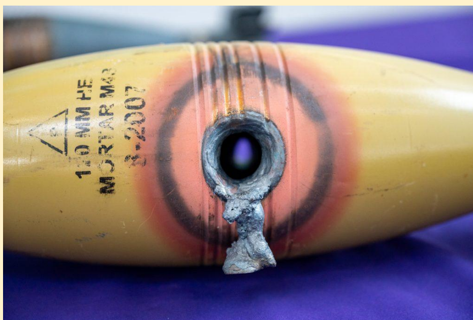
Пропалений лазером мінометний снаряд. Джерело: MILITARNYI
