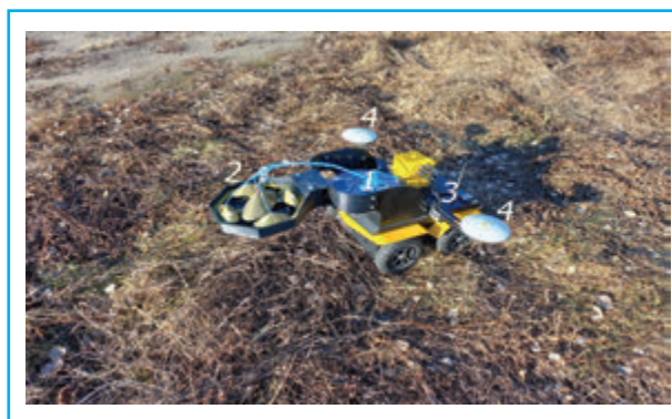
Георадар для виявлення вибухонебезпечних предметів: 1 – апаратний блок, 2 – антена система, 3 – роботизована платформа, 4 – GPS антени
