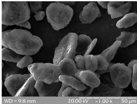
Структура сферидизованого графіту з покриттям для анодів літій-іонних акумуляторів
