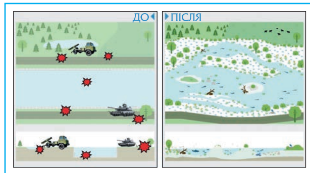
Схема каналізованої ділянки р. Ірпінь, що постраждала від бойових дій, до та після реалізації заходів з ревіталізації
