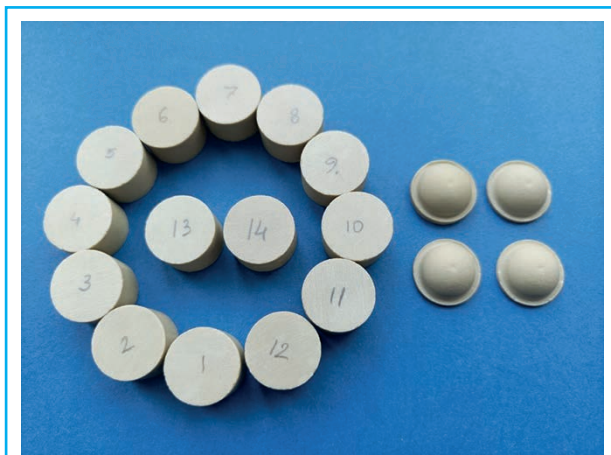
Діелектричні резонатори на частоту \sim 5 \text{ ГГц} – циліндричні та напівсферичні
