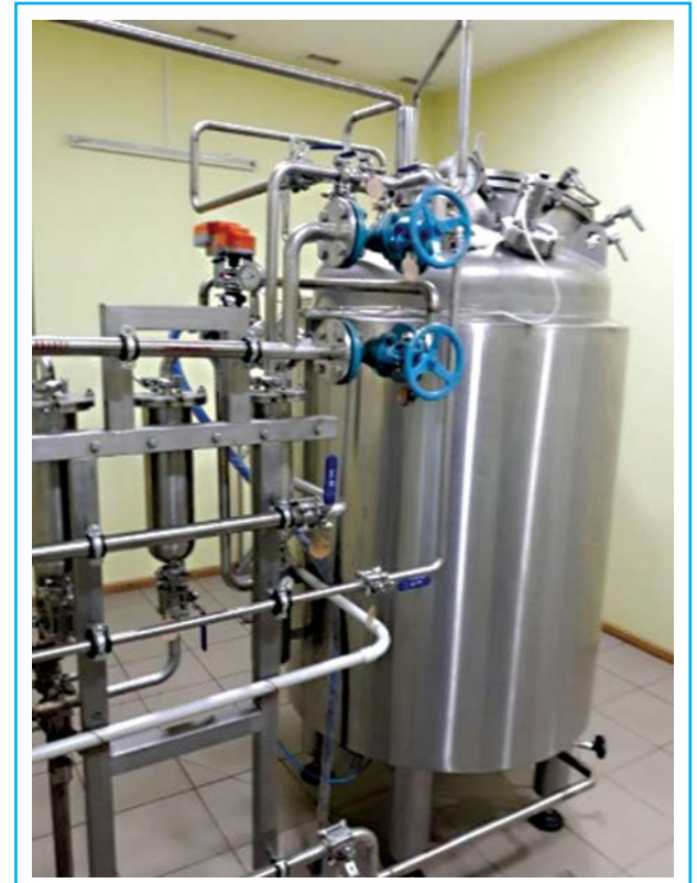
Ферментер для отримання малих партій біопрепарату на основі штаму B. amyloliquefaciens subsp. plantarum IMB B-7524
